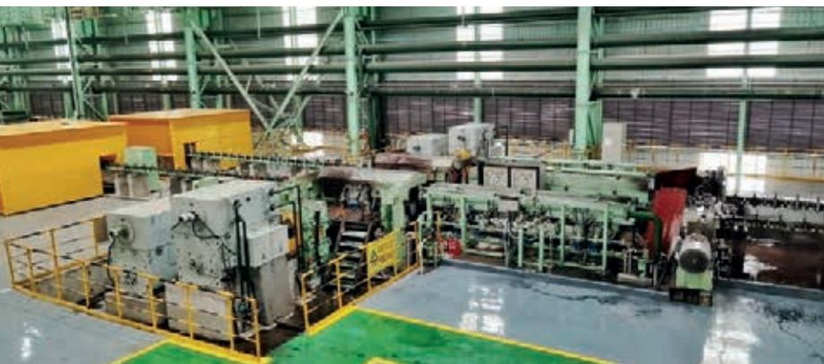
涟钢双高棒项目成功运用了连铸坯直接轧制技术、切分双高棒轧制技术、全国产高速上钢设备和电控系统等多项自主研发成果，最高轧制速度达45m/s；同时结合中钢设备制造的国内最大260mm顶交重载模块轧机、单传260mm减定径机组、智能控冷设备，实现柔性控制冷却以及大规格低温轧制；提高了成材率和产品质量、降低生产成本。
