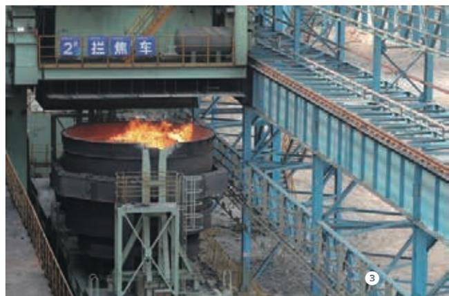
国内大型钢铁企业配套的焦炭生产线及独立焦化企业，其炼焦化学污染物排放均需达到《炼焦化学工业污染物排放标准》(GB16171-2012)，部分地区甚至需实现污水零排放。目前国内7米以下的焦炉，受单孔炭化室容积的限制，装煤量少、结焦时间较短，因此装煤、出焦和熄焦过程操作频繁，产生的阵发性污染物排放较多，也成为了行业内达到“超低排放”甚至“绿色生产”的头等难题。
